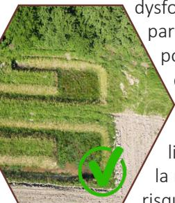
La zone tampon humide artificielle (ZTHA) en sortie de drain limite ces impacts. Cette installation garantit également l'accès à la ressource en eau aérienne pour la faune et la flore et atténue les risques liés à la montée des eaux.
