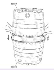
L'installation des clips de serrage se fait successivement et de façon diamétralement opposée sur la jonction des deux coques (et non à la suite). À l'aide d'une personne qui maintient la jonction des deux coques, l'autre personne insère un 1<sup>er</sup> clip de serrage jusqu'au fond dans son emplacement. Un maillet et un morceau de bois peuvent être utilisés si besoin.
